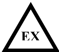
Zona con riesgos de atmósferas explosivas
